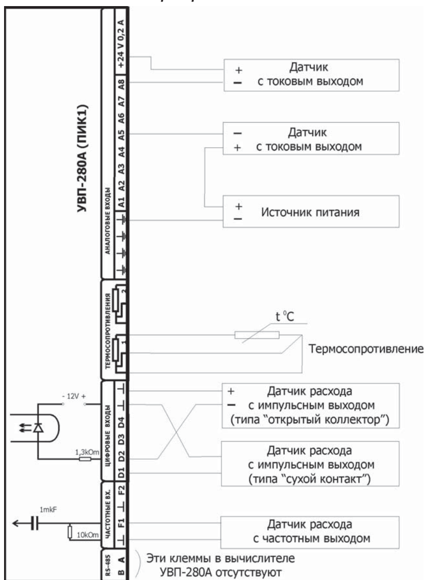
Схемы подключения измерительных преобразователей к вычислителю УВП-280А и вычислителю УВП-280Б с блоком ПИК1
