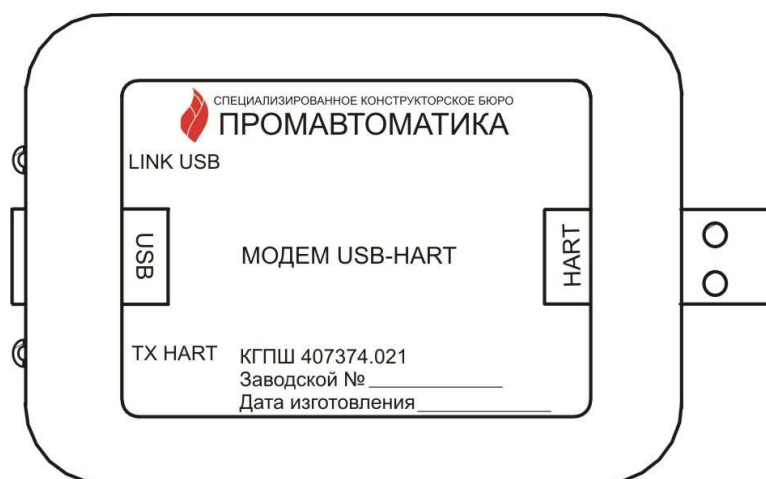
Рис.1 Расположение коммутационных элементов модема
