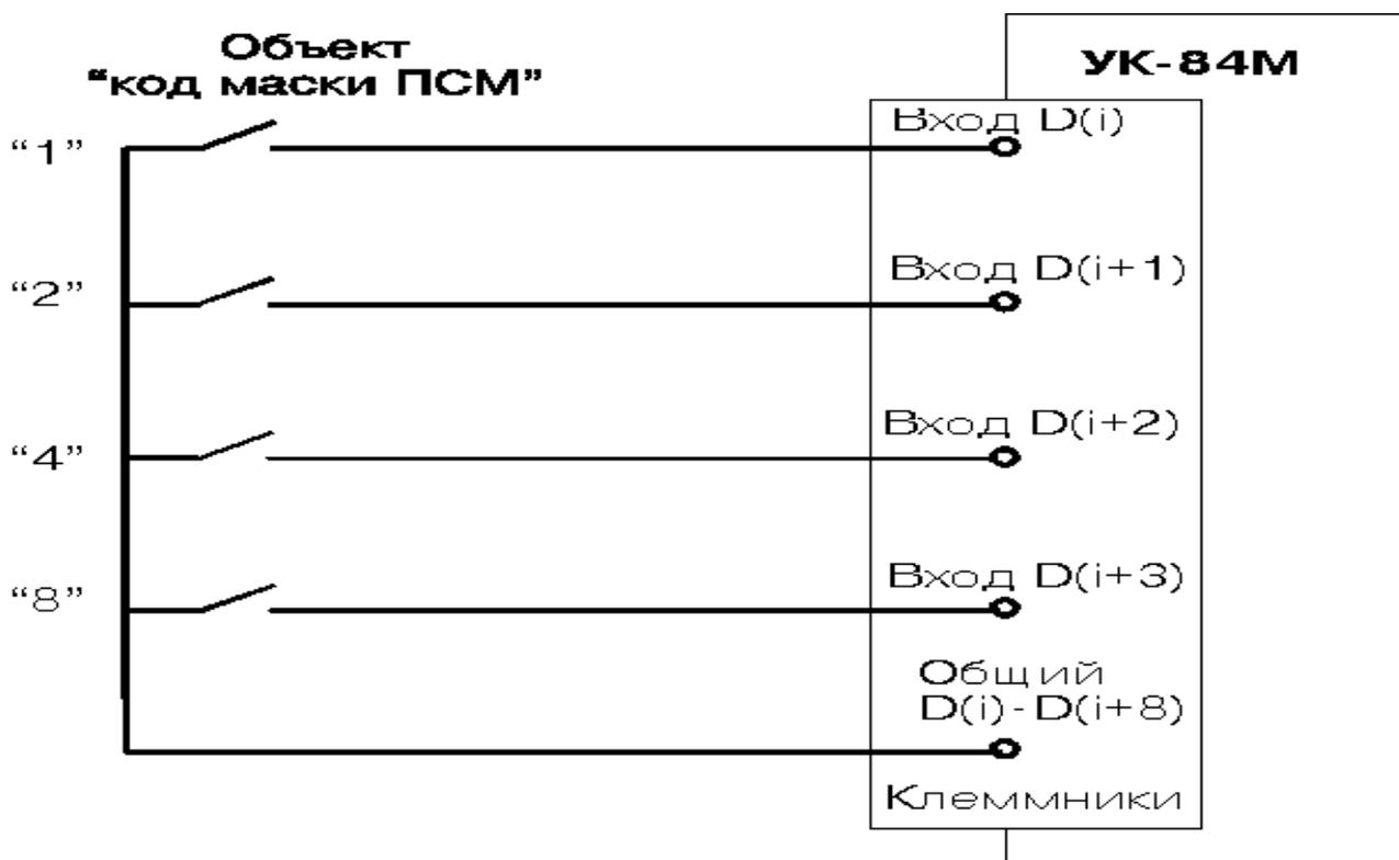
Рис.7 Схема подключения кодов маски ПСМ к ТК-84М1
