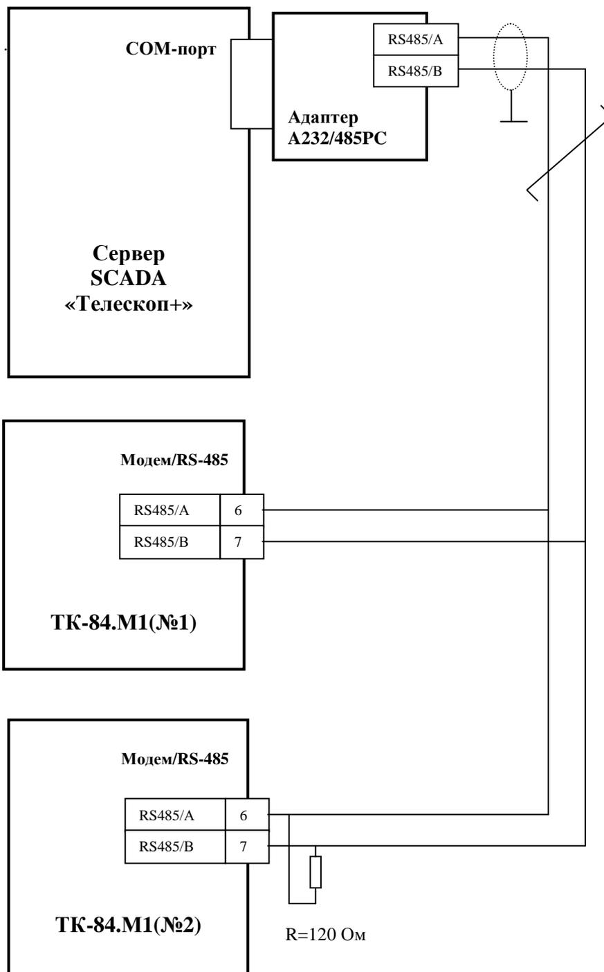
В адаптере А232/485РС устанавливается перемычка, подключающая согласующий нагрузочный резистор 120 Ом
