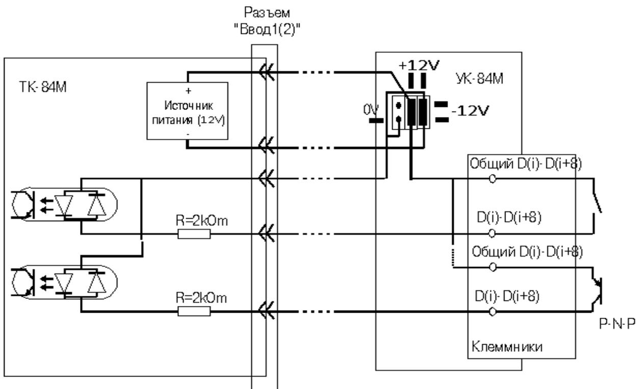
**Рис.4** Схема подключения дискретных датчиков с питанием +12В
