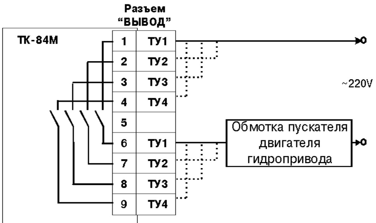
Рис.9 Схема подключения сигнала управления гидроприводом ГЗУ «Спутник»
