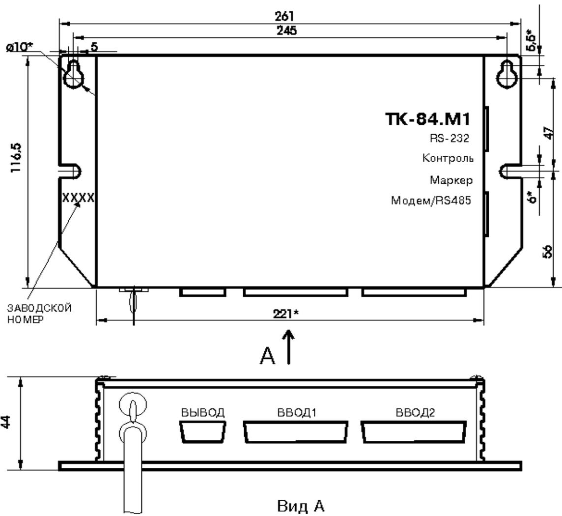
Рис.1 Габаритно-присоединительные размеры контроллера ТК-84М.1
