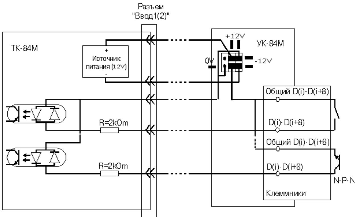
**Рис.5** Схема подключения дискретных датчиков с питанием -12В
