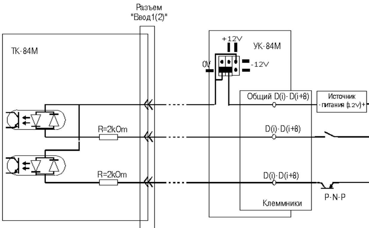
Рис.6 Схема подключения дискретных датчиков с активным выходом
