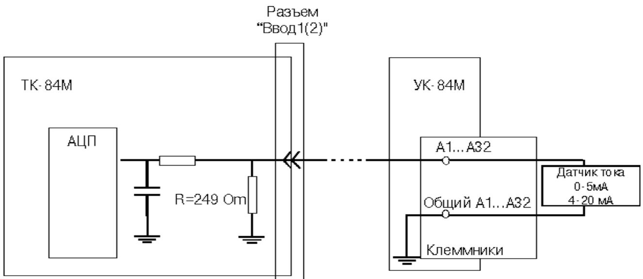
Рис.8 Схема подключения аналоговых датчиков
