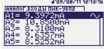
Возможен просмотр информации по выбранному входу A1...A6 со значком ~ в графическом виде, в этот режим можно перейти путем нажатия кнопки *ВВОД*. Работа с графической информацией аналогична порядку, описанному выше в п.2.3.2.2.
