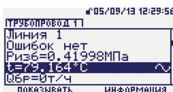
После установки курсора на параметре со значком  $\sim$  вход в режим просмотра графика выполняется кнопкой *ВВОД*. Пример вывода такого графика приведен ниже:
