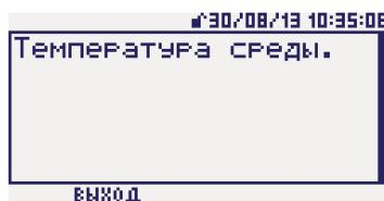
На индикаторе в корневом меню, где отображается список используемых трубопроводов, для каждого трубопровода выводится только один выбранный параметр. Выбор номера трубопровода и параметров и выполняется при помощи кнопок клавиатуры  $\blacktriangle$ ,  $\blacktriangledown$ ,  $\blacktriangleright$ ,  $\blacktriangleleft$ .
