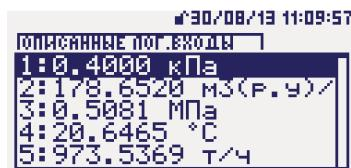
Возможен просмотр информации по выбранному параметру со значком ~ в графическом виде, в этот режим можно перейти путем нажатия кнопки **ВВОД**. Работа с графической информацией аналогична порядку, описанному выше в п.2.3.2.2.
